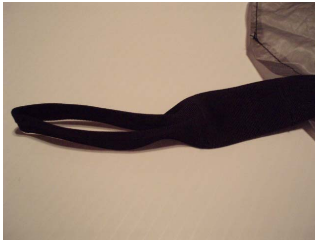
Figure 17 : Assemblage des rubans des coins de la tente.
